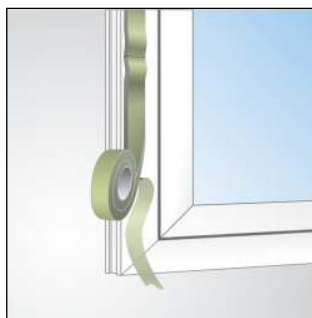
Bild 3: STUMPFSTOß bei der Fenstermontage
