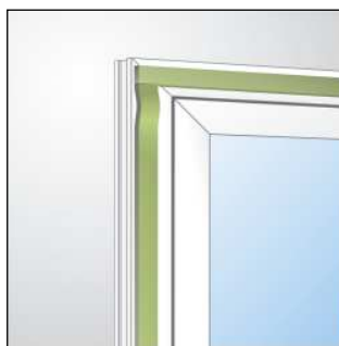
Bild 1: ECKAUSLEGUNG bei der Fenstermontage
