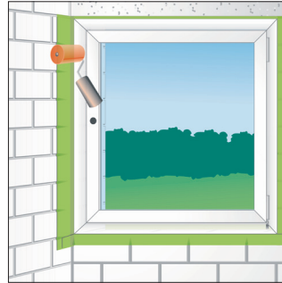
Bild 5: Folie mit einem Andruckroller anrollen
