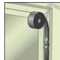
Stumpfstoß bei der Fenstermontage
