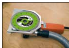
RECA diaflex , eingebaut in spezieller Fenster-Demontagemaschine
